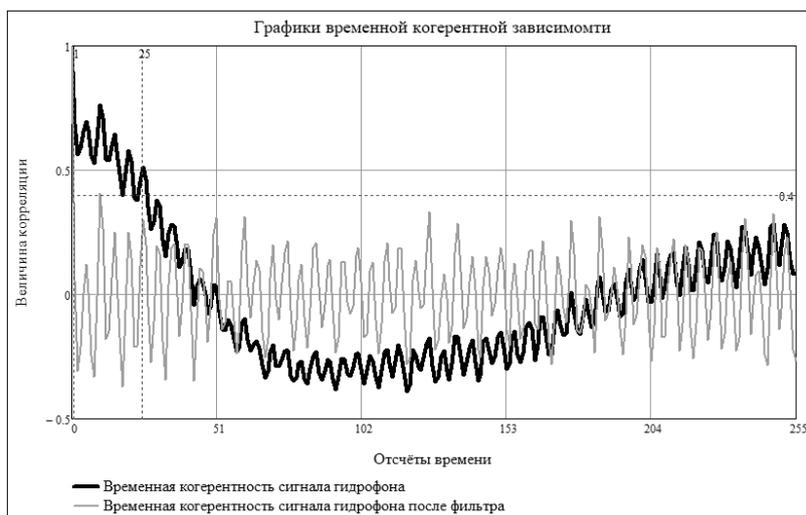
**Рис. 2.** Графики временной когерентности сигнала гидрофона. Пунктирной горизонтальной линией на рисунке определен порог величины корреляции, равный 0,4
